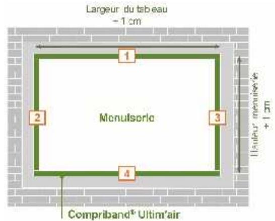
Commencer par mettre en place le Compriband® ULTIM'AIR® sur la partie horizontale haute du dormant en laissant une sur-longueur d'une largeur de joint.
