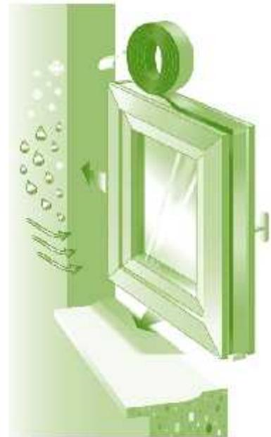
En partie haute et basse, les bandes horizontales recouvrent les bandes verticales, la sur-longueur d'une largeur de joint des bandes horizontales permet d'assurer l'étanchéité de l'angle.
